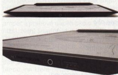
Čelní a boční pohled na NoteSlate a umístění konektorů na spodní hraně
