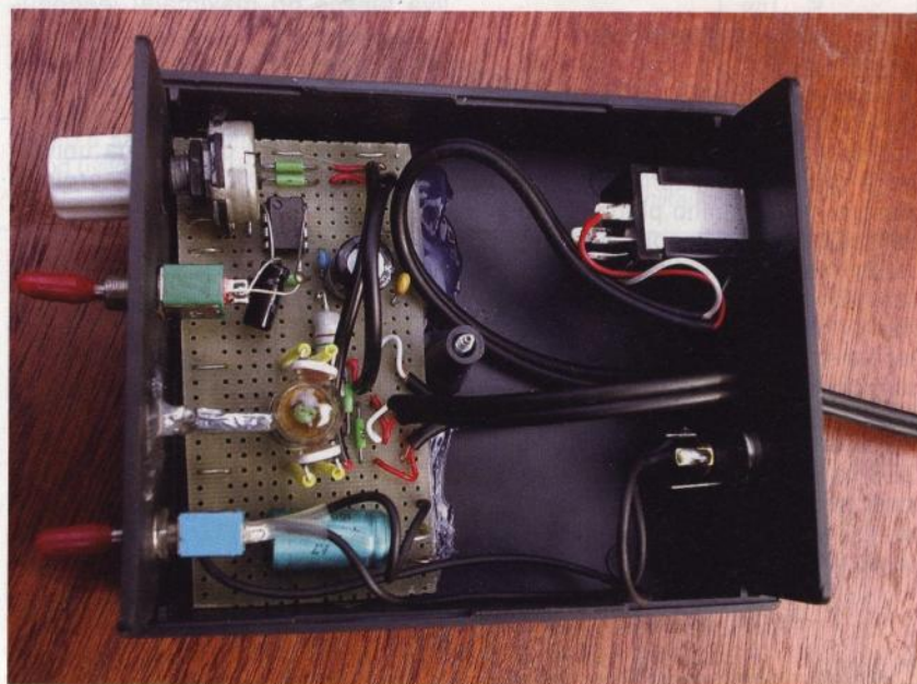
Obr. 2. Pohled dovnitř kompresoru
