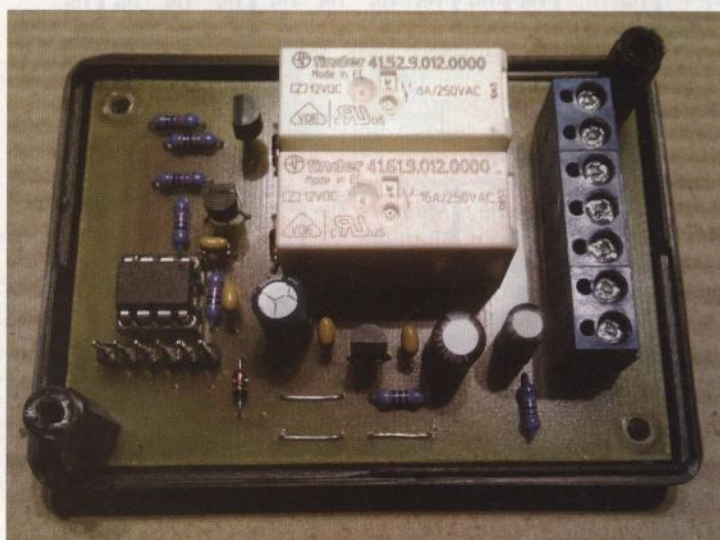
Obr. 8. Deska spínače světel v krabičce bez víka
